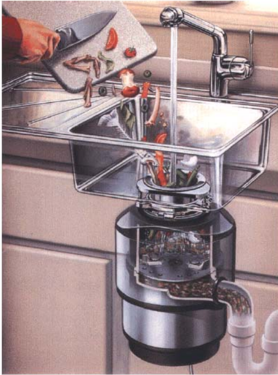
Obr.1 Drtič potravinových odpadů a) v činnosti b) v řezu (ISE, 1999)
